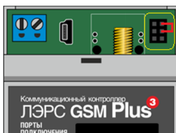
Рисунок 5.1 – Установка перемычки для обновления ПО
